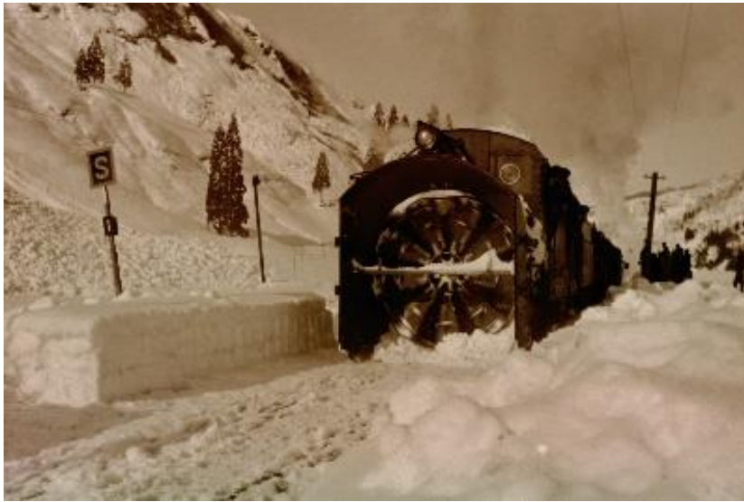
1.機関車 2.マックレー 3.ロータリー 4.機関車 の順に連結された「キマロキ」編成 只見駅前
